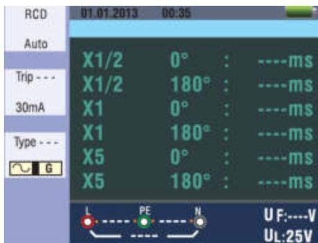
Рис. 14 Ожидание тестирования УЗО- RCD
