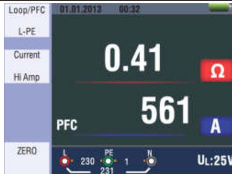
Рис. 9 Результат измерения в режиме Hi Amp LOOP
