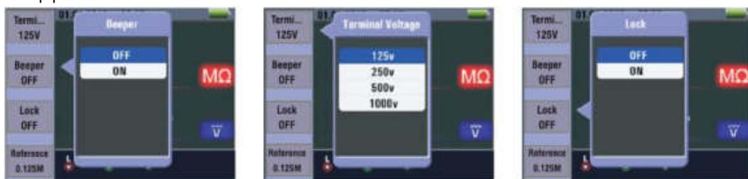
**Кнопка F1:** отображение и сворачивание меню измерения сопротивления изоляции, режим сворачивания активируется на основании выбора пользователя.
