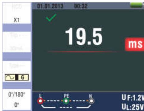
Рис. 17 Результат тестирования УЗО с множителем «x1»
