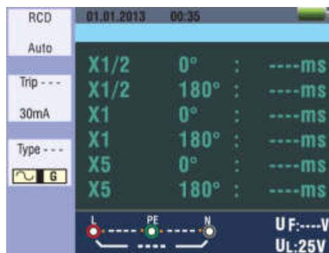
Рис. 16 Тестирование УЗО в автоматическом режиме
