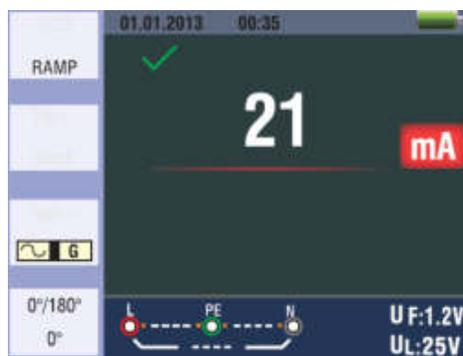
Рис. 18 Результат тестирования УЗО в режиме Ramp
