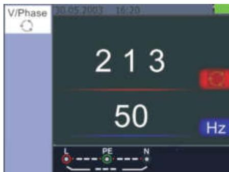
Рис. 24 Чередование фаз при подключении против часовой стрелки
