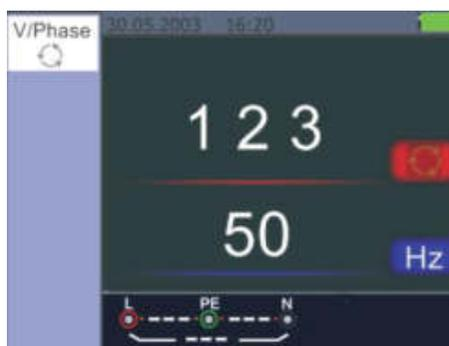
Рис. 23 Чередование фаз при подключении по часовой стрелке
