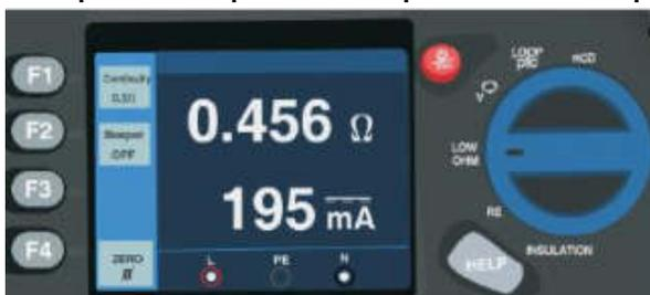
Контроль целостности линии используется для проверки целостности соединений путем измерения сопротивления с высокой точностью. Это особенно важно для проверки соединений защитных заземлений.
