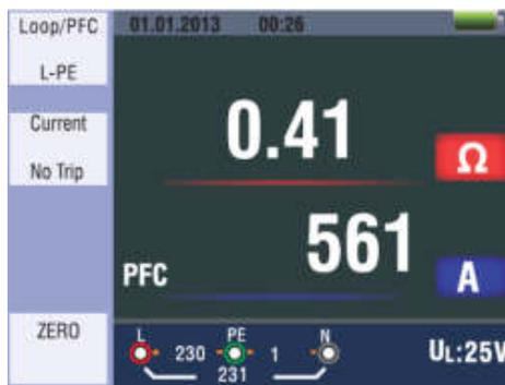
Рис. 5 Выполнено измерение в режиме без размыкания УЗО - No Trip
